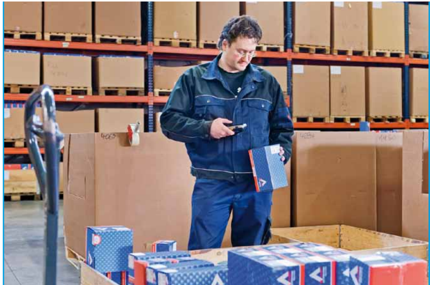
Mit dem 2D-Barcodescanner werden Barcode und GS1 DataMatrix, die beide in das hybride Verpackungsetikett integriert sind, erfasst.
