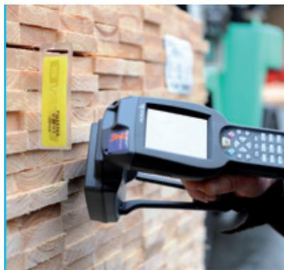
RFID gestützter Erfassungsprozess
