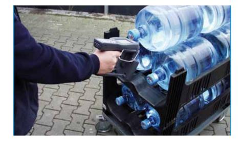
bis 20 Zentimetern, was für die Belieferung der meisten Endkunden vollkommen ausreicht. Pulkerfassungen der vollen Flaschen durch RFID-Gates oder mithilfe des MDA sind durch die starke Störwirkung des Wassers bisher nicht realisierbar. Dem Gesamterfolg des Projekts tut dies jedoch keinen Abbruch.
